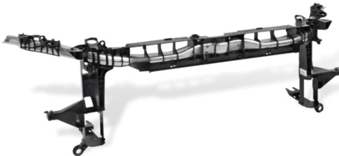
Bild 10.1 Frontend-Montageträger Mercedes A-Klasse [Bildquelle: Daimler AG]
