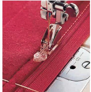
Reißverschlussfuß – ermöglicht exaktes Steppen, weil die Nählinie gut beobachtet werden kann.
