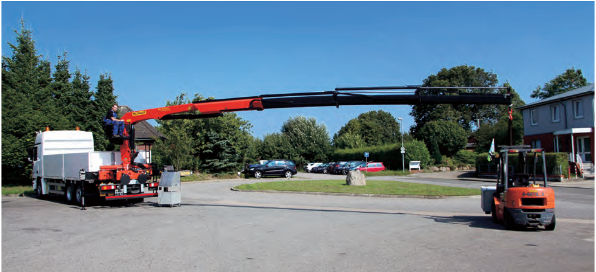
1 Max. Last festlegen mit ausgefahrenen Stützen nach Kransoftware
