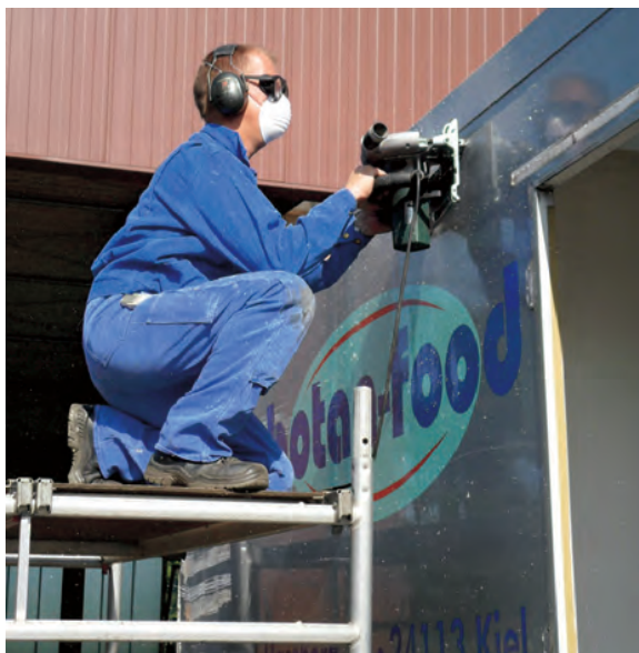
3 Seitenwand ausschneiden – hier waagerechter Schnitt oben
