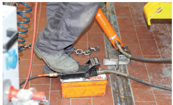
5 Öldruckpumpe zur Betätigung des Druckzylinders
