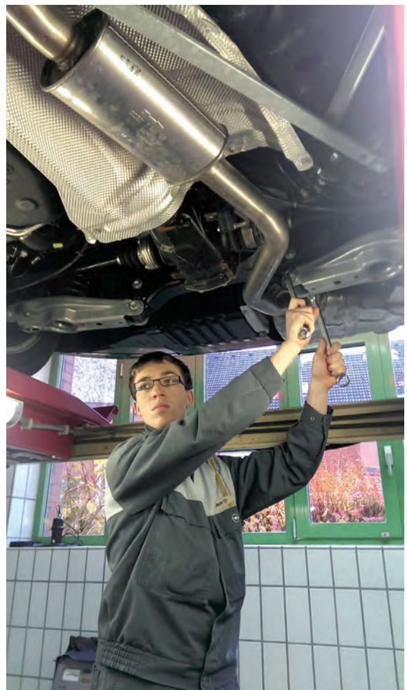
2 Sturz links an der Hinterachse einstellen
