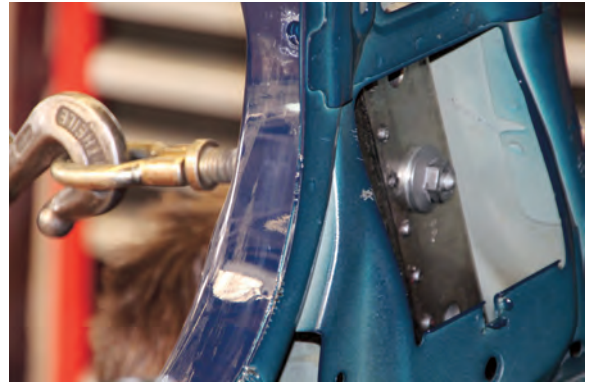
2 Kettenbefestigung an der B-Säule
