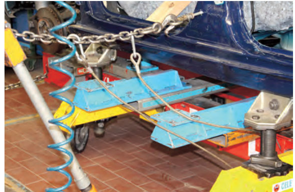
3 Sicherung der Zugketten durch Stahlseile
