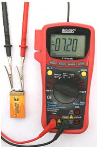
Um eine sinnvolle praktische Anwendung des *SerialPort*-Controls mit geringstem Aufwand zu demonstrieren, verwenden wir hier als Peripheriegerät ein Digitalvoltmeter (z.B. DT9602R) mit serieller Schnittstelle<sup>1</sup>. Es dürfte aber auch jedes andere DVM mit serieller Schnittstelle geeignet sein. Die folgende Abbildung zeigt das DVM beim Messen einer Batteriespannung, oben sieht man das Kabel, welches zum seriellen COM-Port des PC führt.
