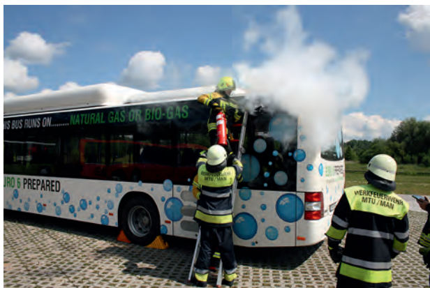
Bild 1: Einblasen von Kohlendioxid in die Luftansaugung
