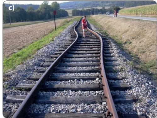
Bild 3.39: Berücksichtigung der Temperaturexpansion (a, b) und Verzug durch Wärmeausdehnung bei Schienen (c)
