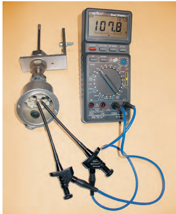
1 Ermittlung des Widerstandswertes eines Temperatursensors
