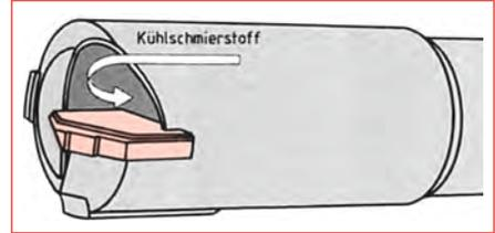
Bild 2 Einrohrbohrer zum Bohren ins Volle
