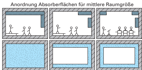
Abb. oben: Raumlängsschnitt Abb. unten: Deckenuntersicht
