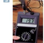
Ein Sägewerk hat eine Trockenkammer für Holz. Lesen Sie am Feuchtigkeitsmesser ab, wie viel % Feuchtigkeit das eingelagerte Holz hat.
