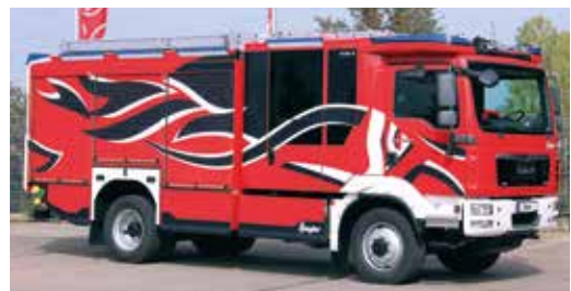
HLF 20 mit der Z-Cab XL bei der ersten offiziellen Präsentation. Im Mannschaftsraum können acht Plätze mit PA-Halterungen (inklusive Gruppenführer-Platz) ausgestattet werden.
