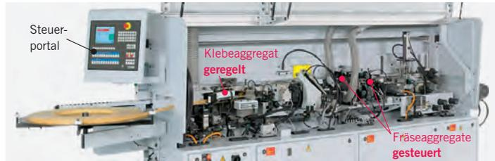
1 Steuerung und Regelung an einer Kantenanleimmaschine (*edge banding machine*)
