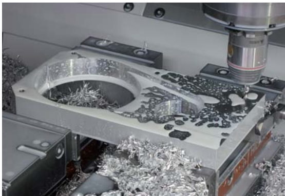
7 Bohren der Gewindekernlöcher M8
