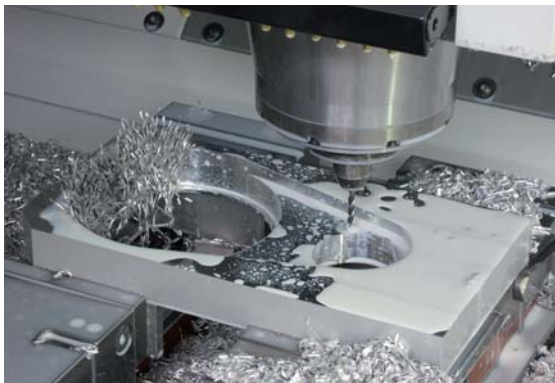
5 Bohren der Gewindekernlöcher M5
