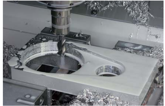
4 Schlichten der großen Lagerbohrung \varnothing 140H7
