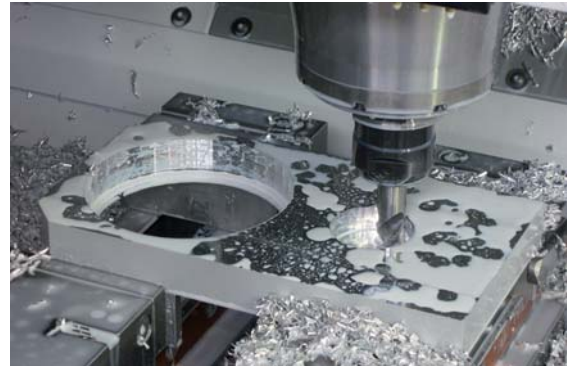
2 Schruppen der kleinen Lagerbohrung \varnothing 55H7
