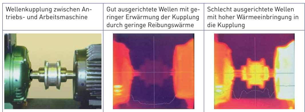
Bild 1: Notwendigkeit einer guten Wellenausrichtung für hohe Wirkungsgrade
