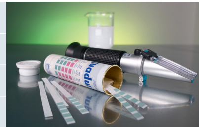
Handrefraktometer und Teststäbchen für Kühlschmierstoffe
