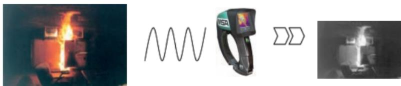
**Bild 8a:** Die Kamera hat freie Sicht auf die Wärmequelle und kann die Temperaturunterschiede im Monitor als Bild darstellen. [Fotos: Forschungsstelle für Brandschutztechnik an der Universität Karlsruhe, Fa. MSA Auer]
