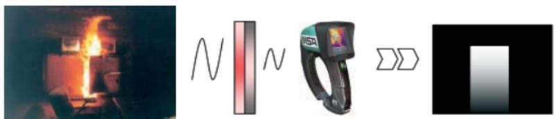
**Bild 8c:** Ein Wärmedurchgang durch das Hindernis hat teilweise (im Bereich einer Tür) stattgefunden. Auch die der Kamera zugewandte Seite des Hindernisses ist nun erwärmt und emittiert Wärmestrahlung, die von der Kamera abgebildet werden kann.
