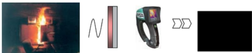
**Bild 8b:** Ein Hindernis (Wand) befindet sich zwischen der Wärmequelle und der Kamera. Die Beaufschlagung des Hindernisses mit Wärme reicht noch nicht aus, um eine Temperaturveränderung auf der der Kamera zugewandten Seite zu bewirken. Die Kamera kann keinen Hinweis auf die Wärmequelle liefern.
