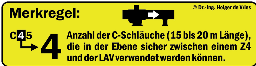
Abbildung 42: Merkregel für die Anzahl der C-Schlauchlängen zwischen Z4 und LAV
