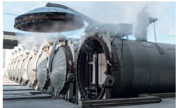
Das Härten der Rohlinge erfolgt in Autoklaven
