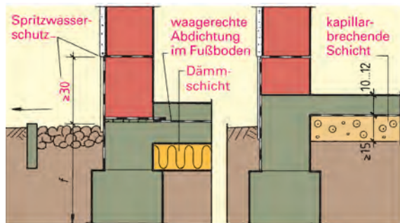
Abdichtung nicht unterkellertes Gebäude (gegen Bodenfeuchtigkeit)
