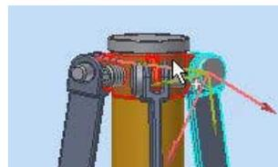
Untersucht werden sollen der Gewichtarm, der Bolzen und die obere Gleitbuchse.
