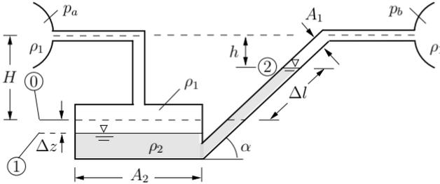
**Lösung** Wir sehen die Dichten in den Gasen als konstant an. Dann können wir die Gase wie Flüssigkeiten behandeln. Die Drücke in den Trennflächen im Gefäß (Höhe ①), bzw. im Steigrohr (Höhe ②) sind somit nach der hydrostatischen Druckgleichung durch
