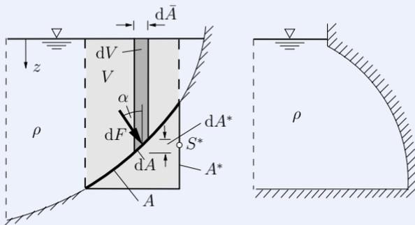
Die Horizontalkomponente  $F_H$  ist das Produkt aus der projizierten Fläche  $A^*$  und dem Druck  $p_{S^*}$  im Schwerpunkt  $S^*$  dieser Fläche:
