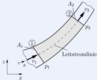
**Bernoullische Gleichung:** a) Für reibungsfreie Flüssigkeiten (Strömungen ohne Energieverluste) gilt
