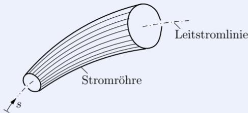
**Kontinuitätsgleichung:** Das pro Zeiteinheit durch einen beliebigen festen Querschnitt strömende Flüssigkeitsvolumen (Volumenstrom:  $Q = A v$ ) ist konstant:
