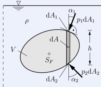
Die Wirkungslinie des Auftriebs geht durch den Schwerpunkt  $S_F$  der verdrängten Flüssigkeitsmenge.
