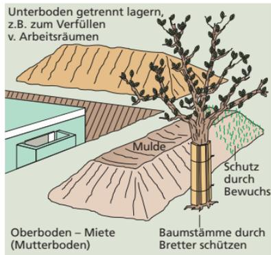
Zur langfristigen Lagerung des Oberbodens über Jahre ist es möglich, eine Fläche bis zu 1,00 m hoch waagrecht abzulagern. Der Boden bleibt so über Jahre hinaus lebensfähig. Nach DIN 19731 darf dabei die maximale Schütthöhe von 2,00 m nicht überschritten werden.
