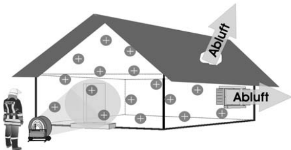
Bild 1: Überdruckbelüftung – Luftströmung in einem Gebäude (Grafik: Verfasser)
