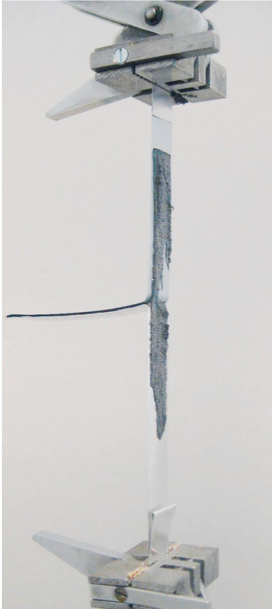
**BILD 4.9** Schälversuch nach FTM 2, Haftung eines Dichtklebstoffes zwischen zwei flexiblen Metallfolien (Quelle: VITO Irmen GmbH & Co. KG, Remagen)
