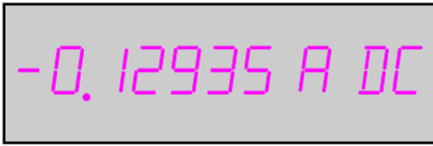
Bild 1.8 Anzeige eines digitalen Multimeters in der Betriebsart Strommessung
