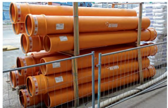
**PP-Rohre mit werksseitig aufgesteckter Muffe**
