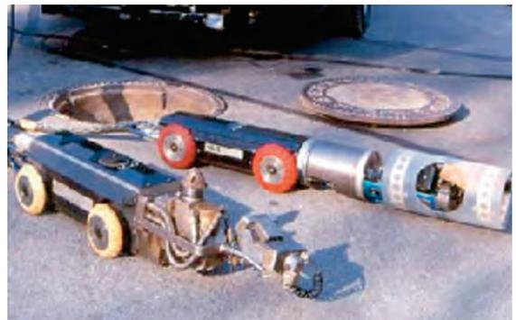
Mit Kanalrobotern wird in Rohren mit einer Nennweite von DN 100 bis DN 800 gearbeitet
