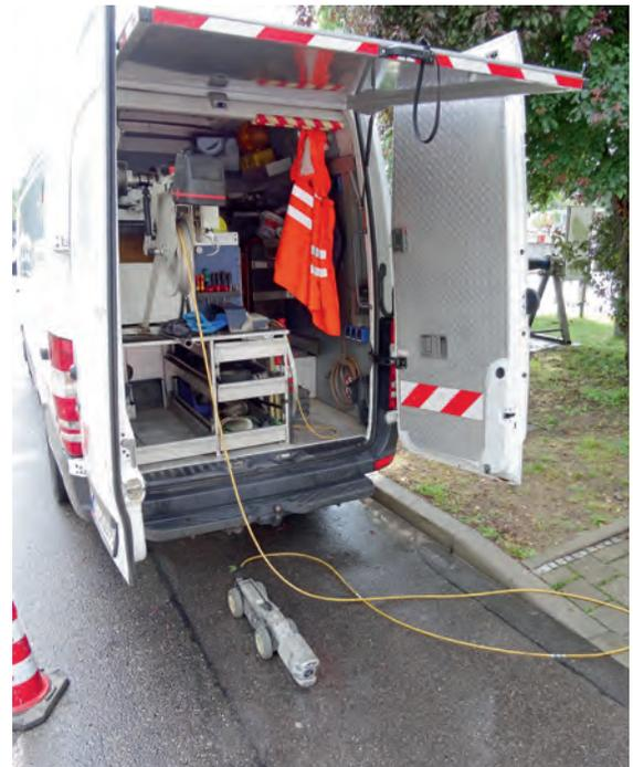
Inspektionsfahrzeug mit Kanalroboter
