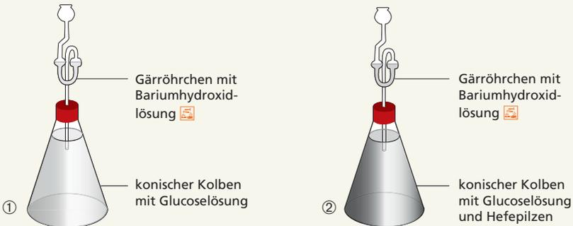
Gasentwicklung im Kolben ②, milchigweiße Trübung der Bariumhydroxid-Lösung im Gärröhrchen ②. Keine Veränderung im Kolben ① und im Gärröhrchen ①.
