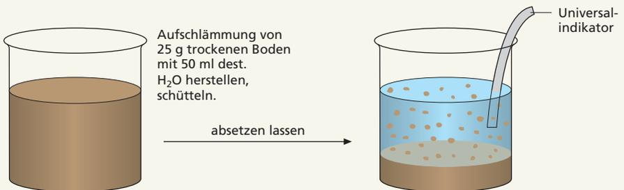
Die Verfärbung des Indikators zeigt den Säure- bzw. Basengehalt des Bodens an (rot: sauer; grün: basisch). Das Ergebnis mit der Farbskala vergleichen.
