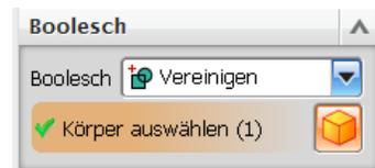
Bei den in Grundkörpern bzw. Ziehbefehlen integrierten booleschen Operationen bildet der neue Körper das Werkzeug. Bei der Verwendung von Formelementen ist mit der Auswahl des Befehls auch die boolesche Operation festgelegt. So werden beispielsweise **BOHRUNGEN** subtrahiert und **POLSTER** vereinigt.
