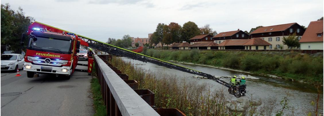
Abb. 101: Einsatz der Drehleiter im Rahmen der Wasserrettung. Mit Hilfe einer Drehleiter mit Gelenkarm und einer Waagrecht-Senkrecht-Abstützung lässt sich mit dem Rettungskorb ein großer Unterflurbereich erreichen.
