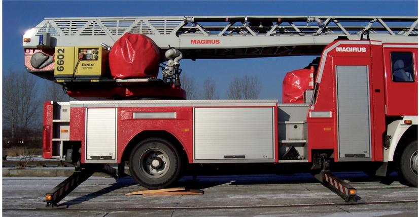
Abb. 103: Herstellung einer zusätzlichen Schräglage durch Unterlegen der Auffahrbohlen unter die Reifen der Hinterachse auf der dem Gewässer abgewandten Fahrzeugseite bei einer Magirus-Drehleiter.
