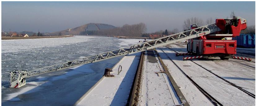
Abb. 104: Verringerung des toten Winkels unterhalb einer Kaimauer durch Platzierung der Drehleiter in einem Abstand von ca. 7,00 m von der Kaimauer entfernt (Abstand Kaimauer ↔ Fahrzeugkante), bzw. 8,50 m (Abstand Kaimauer ↔ Drehkranzmitte).
