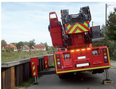
**Abb. 102: Schrägstellung einer Metz/Rosenbauer-Drehleiter um  $7^\circ$  durch einseitiges Ausfahren der Abstützzyylinder.**
